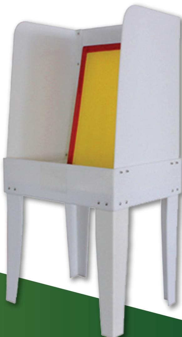
La vasca di lavaggio è uno strumento necessario ed essenziale per mantenere un corretto controllo dello **smaltimento dei prodotti chimici** e di **pulizia del recupero dei telai serigrafici**.
