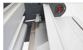
Pressino con discesa automatica per il bloccaggio del materiale da tagliare
