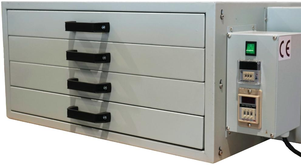
Il forno viene utilizzato per asciugare il telaio dopo la stesura di emulsione fotosensibile o a seguito del lavaggio.
