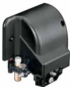
La sua semplicità ha reso la tecnologia con **lama auto-pilotante** (auto-rotante) la più diffusa. Un parametro di compensazione definisce la distanza tra la punta della lama e il suo asse di rotazione. Affinché la lama assuma il corretto orientamento nella direzione di taglio all'interno del proprio porta-lama, viene eseguito un movimento in modo che la punta della lama si auto-orienti.
