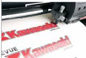
I **rulli** che sorreggono il **supporto** e le **flange** da inserire agli estremi dei rotoli caricano il vinile in modo corretto e lo mantengono allineato anche quando tagliate alla massima velocità.
